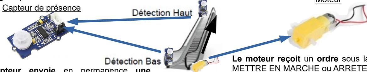
Le capteur envoie en permanence une information codée sous la forme de 0 ou 1.
