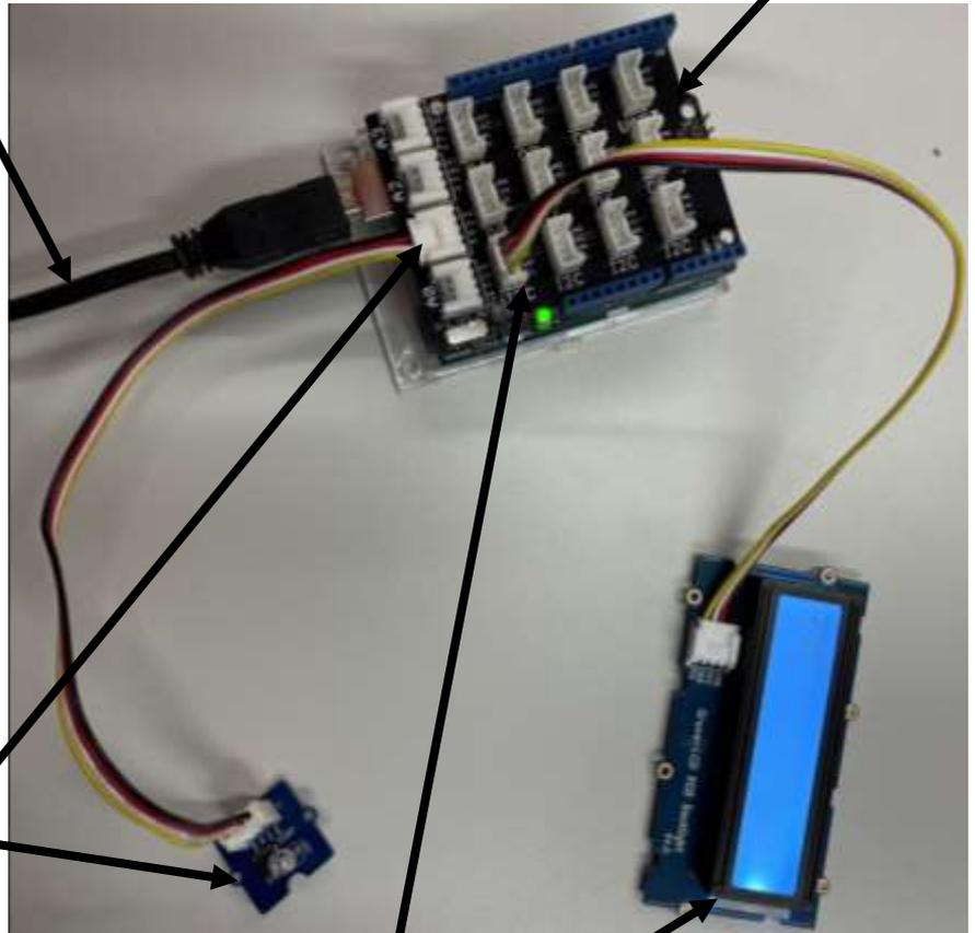
2°) Brancher le capteur de lumière sur l'entrée analogique A1.
